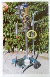
Die druckluftbetriebenen Kolbenpumpen der Firma MGVMoest-Spritzgeräte sind Bauserien von Hochdruckpumpen
